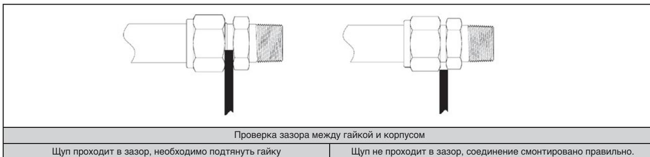
Проверка зазора между гайкой и корпусом
