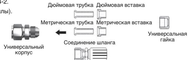
AN Соединитель с AN резьбой и монтажной гайкой
