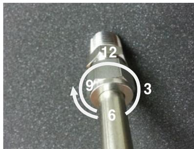
Вставьте трубку до упора в фитинг и закрутите гайку вручную.
