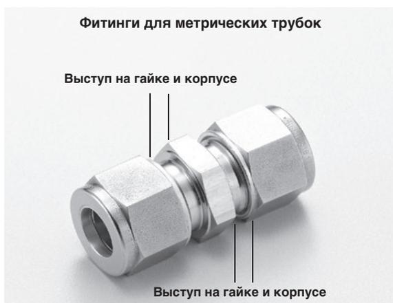
Метрические фитинги визуально отличаются от дюймовых наличием специальных выступов на корпусе фитинга, а так же на гайке.
