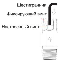
1. Ослабьте немного фиксирующий винт.
